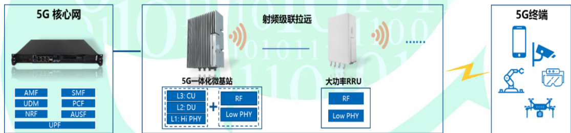
图 14 远拉组网架构图
